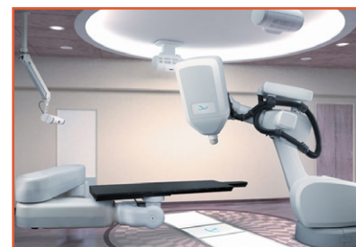
數碼導航刀安裝於天花的一對「定位X光機」及「呼吸同步系統」
